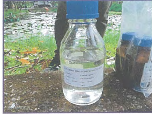
ภาพที่ 1-2 แสดงการเก็บตัวอย่างคุณภาพน้ำผ่านการบำบัด (ก่อนลงบ่อบัว)
