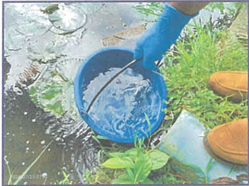
ภาพที่ 1-2 แสดงการเก็บตัวอย่างคุณภาพน้ำผ่านการบำบัด (ก่อนลงบ่อบัว)
